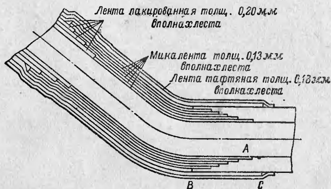
Рис. 12. Сопряжение изоляции пазовой и лобовых частей.
